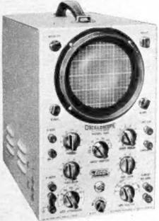
12,5-cm-Bildröhre mit Flutlichtrasterabscheibe und kontinuierlicher Helligkeitsregelung, Strahlverschiebung horizontal und vertikal, Rücklaufaustastung, Helligkeitsmodulationsanschluß, Eichspannung, 50 Hz und Sägezahnaustrag.
