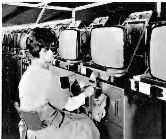
Prüfautomat im Bildröhrenwerk Eßlingen der SEL
