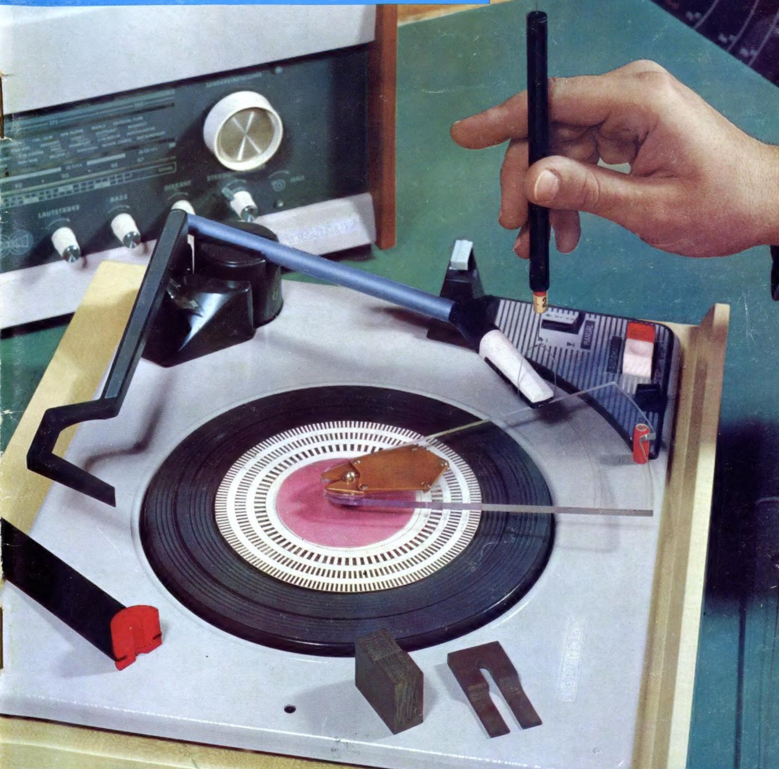
**Prüfung des Auflagegewichtes eines Tonabnehmers mit der Federwaage in einer Servicewerkstatt; siehe unsere Titelgeschichte auf Seite 162 Aufnahme: Cantzler**
