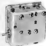
**UHF-Converter-Tuner**, mit Transistoren 2 × AF 139, zum Einbau in jeden Fernsehempfänger. Die Abstimmung erfolgt kapazitiv und nahezu frequenzlinear. Unterersetzung 1 : 8,5; Ant.-Eingang 240 Ω; Ausgang 240 Ω 46.—
