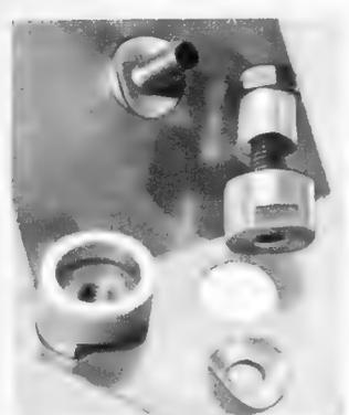
In 1½ Min. werden mit dem **Rekordlocher** einwandfreie Löcher in Metall und alle Materialien gestanzt. Leichte Handhabung — nur mit gewöhnlichem Schraubenschlüssel. Standardgrößen von 10-65 mm Ø, von DM 9,75 bis DM 52.—
