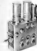
**UHF-Tuner**, mit den Röhren PC 86 und PC 88, ZF = 38,9 MHz, entspricht der allgemein bekannten Ausführung, für alle moderneren Empfängertypen. 43.—
