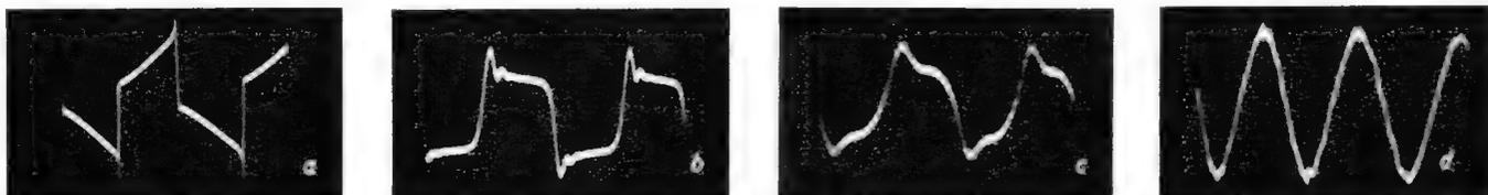
Bild 1. Schirmbilder eines Rechteckimpulses nach Aufnahme und Wiedergabe über ein halbprofessionelles Tonbandgerät, a = 100 Hz, b = 1 kHz, c = 5 kHz, d = 10 kHz
