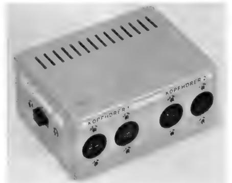
**Bild 2. Umschaltgerät für Kopfhörerwiedergabe UG 8**
