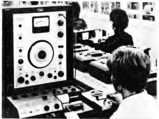
Die Pegelschreiber-Anlage in der Endkontrolle der Uher-Tonbandgeräte-Fertigung
